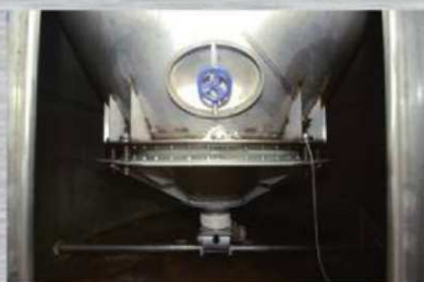
Vue avant du fond vibrant réalisé par les Ets BRUN Frères
